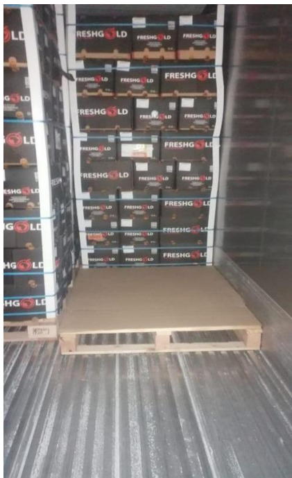
Figuur 3: Voorbeelde van 'n houtbasis met geriffelde kartonne en lugsakke. Let daarop dat een stuk onbeskadigde geriffelde karton bo-op die paletbasis is.
